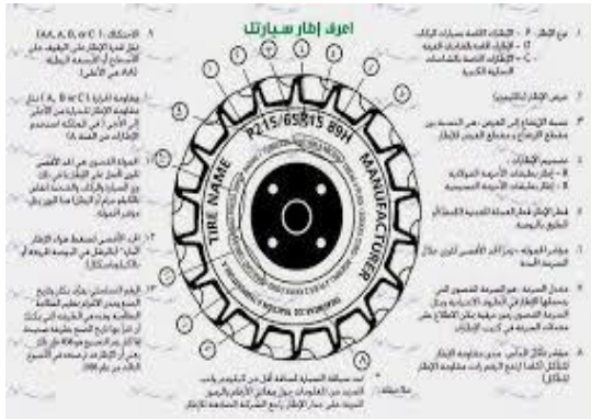
شكل رقم ( ٩ ) يوضح كيفية قراءة البيانات المدونة على الإطار والسرعات (م ١٧)
